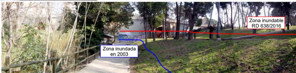
A partir del análisis topográfico de la zona, el nivel alcanzado en 2003 y la altura que supondría una crecida de 500 años, se puede establecer la cota máxima inundable.
